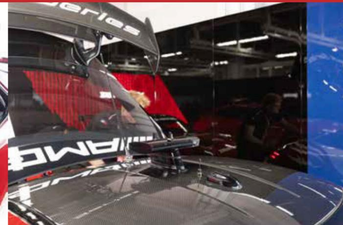
システムテストに用いられていたセーフティーカーの様子。トランク内にレースカーと同様の機材が積み込まれている。
