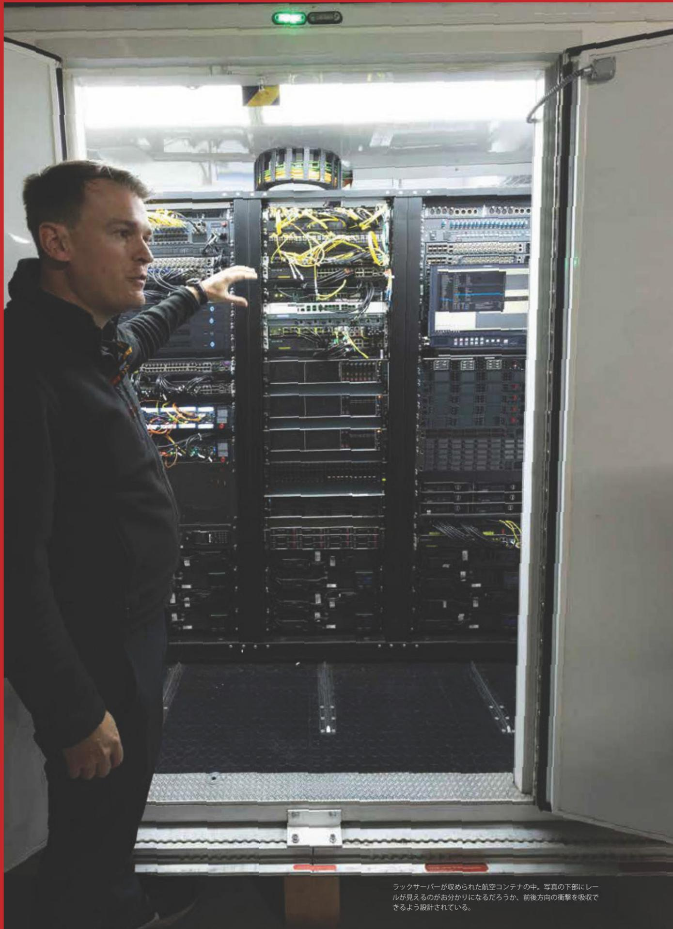
ラックサーバーが収められた航空コンテナの中。写真の下部にレールが見えるのがお分かりになるだろうか、前後方向の衝撃を吸収できるように設計されている。
